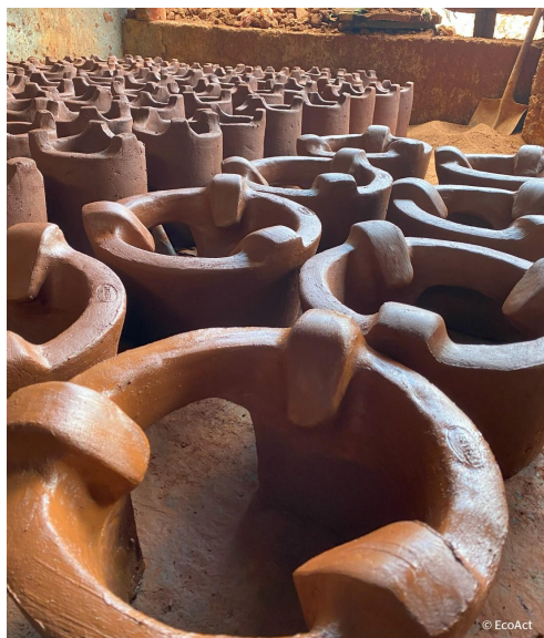
Construction des foyers de cuisson améliorés dans un centre local
